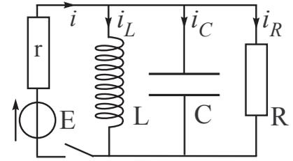
1) Déterminer, par un raisonnement physique simple (pratiquement sans calcul), la tension  $u$  et les intensités  $i$ ,  $i_L$ ,  $i_C$  et  $i_R$  dans les quatre branches :
