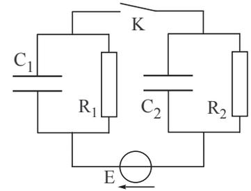
• Loi des nœuds :  $i = i_{R1} + i_{C1} = \frac{u_{R1}}{R_1} + \frac{dq_1}{dt}$
