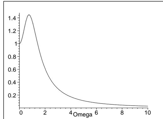
Or,  $\lambda = VT = V \frac{2\pi}{\omega}$ , donc, la distance  $\lambda_m$  entre les ondulations du sol qui commande la résonance des oscillations du châssis si le véhicule roule à vitesse  $V$  constante est :
