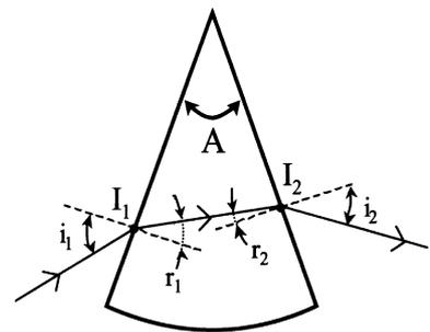
I.2.e) On constate expérimentalement que l'angle  $D$  prend une valeur minimum  $D_m$  lorsque l'on fait varier l'angle d'incidence  $i_1$ .
