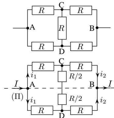
**Propriété :** Deux points symétriques par rapport à un plan de symétrie des courants (II) du réseau ont même potentiel électrique.
