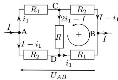
**Conclusion** :  $U_{AB} = R_{\text{éq}}I$ , avec  $R_{\text{éq}} = \frac{R(R_1 + R_2) + 2R_1R_2}{R_1 + R_2 + 2R}$
