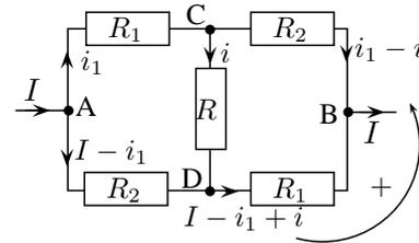
$$-R_2(I - i_1) - R_1(I + i - i_1) + R_2(i_1 - i) + R_1i_1 = 0$$
