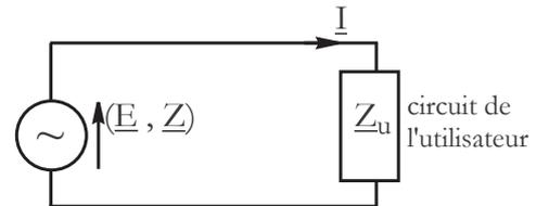
• Loi de POUILLET :  $\underline{I} = \frac{\underline{E}}{\underline{Z} + \underline{Z}_u}$  avec  $\underline{Z} = R + jX$  et  $\underline{Z}_u = R_u + jX_u$ .
