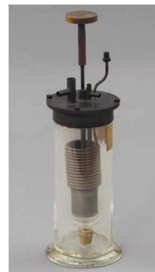
Instrument conçu par Olszewski pour la mesure de T_{\text{inv}}(\text{H}_2) par DJT (1901)
