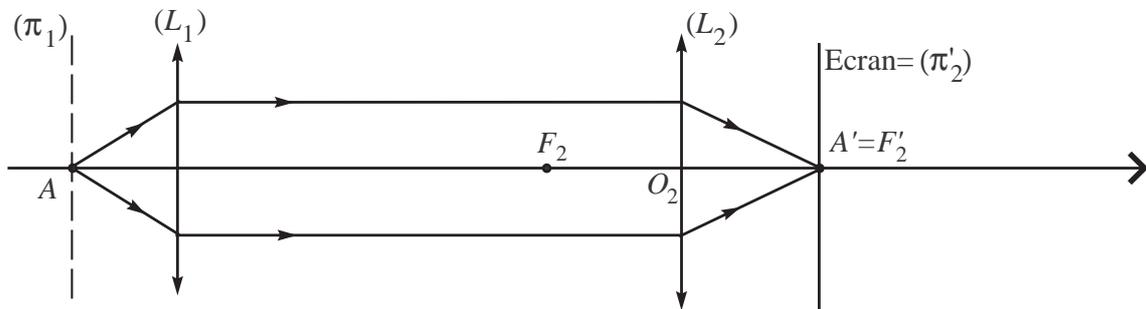
Introduire alors la lentille divergente de focale  $f'$  dans le plan focal objet de la lentille collectrice. Rechercher la nouvelle image  $A''$  de  $A$  en éloignant l'écran d'une distance  $d$  que l'on mesurera.
