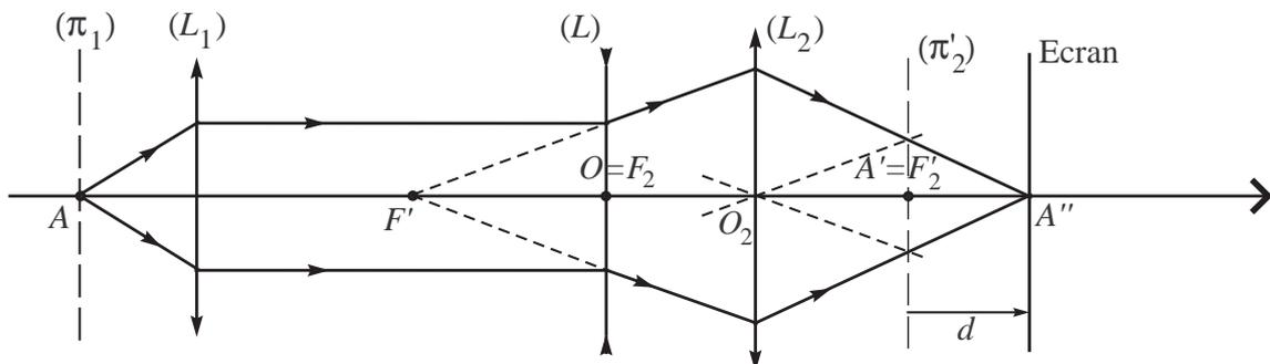
Montrer à l'aide de la formule de NEWTON appliquée à la lentille collectrice que :  $f' = -\frac{f_2'^2}{d}$ . En déduire la distance focale  $f'$  de la lentille divergente.
