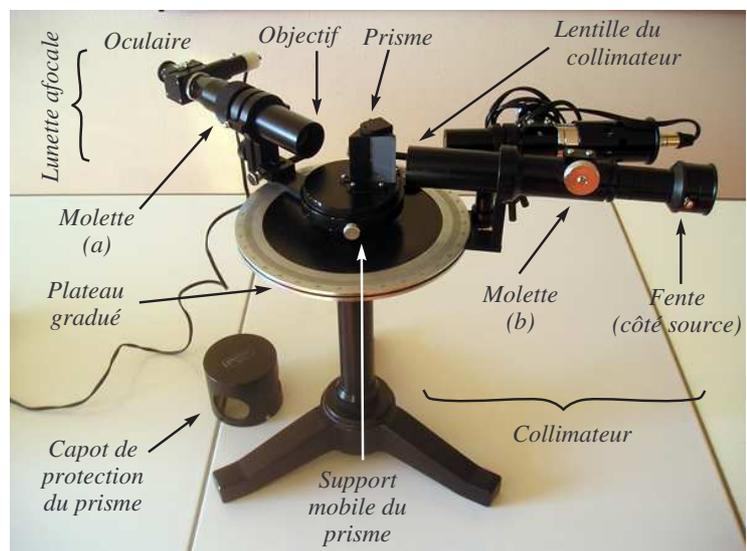
**1) La lunette :** Elle est destinée à observer l'image d'objets à l'infini se formant dans le plan du réticule. Le premier réglage à effectuer est le tirage de l'oculaire qui doit donner du réticule une image à l'infini visible sans accommodation par un œil normal ou bien corrigé. On ajuste ensuite le tirage de l'objectif pour pouvoir observer à l'infini : ici, par auto-collimation, puisque la lunette est pourvue de ce dispositif (→ Cf TP-Cours TP3/O7).
