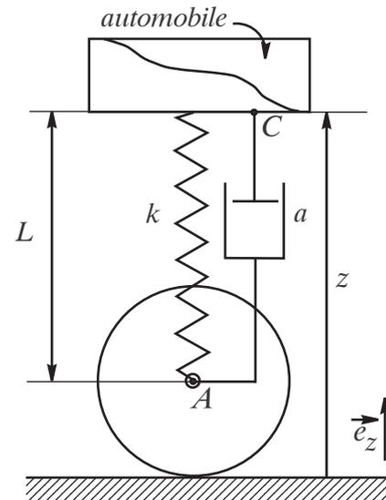
**1)** Le véhicule étant immobile, sans freins, sur un sol horizontal, quelle est la longueur  $L_e$  des ressorts *au repos* et la garde au sol  $z_0$  du véhicule correspondante ?
