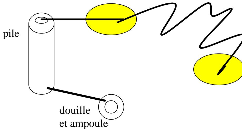
Branche une extrémité du dernier fil électrique à la douille. Donne la forme d'un crochet à l'autre extrémité.
