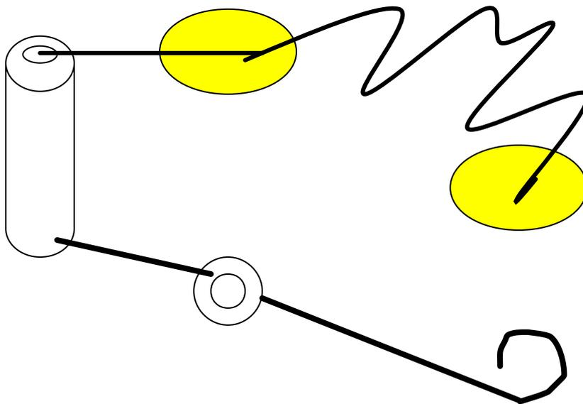
Principe du jeu : Prends le fil de fer dans le crochet et faire avancer le crochet en évitant de toucher le fil ! Si le crochet touche le fil de fer, l'ampoule s'allume !
