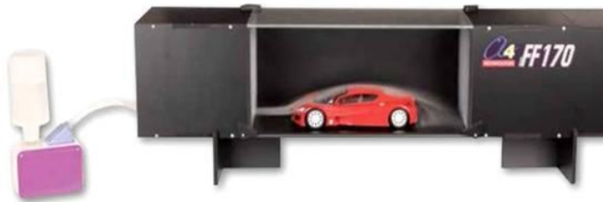
Maquette de véhicule à l'échelle 1/20 ème dans une soufflerie pour vérifier l'aérodynamisme
