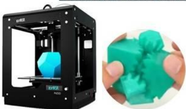
Par addition de matière avec une imprimante 3D.
