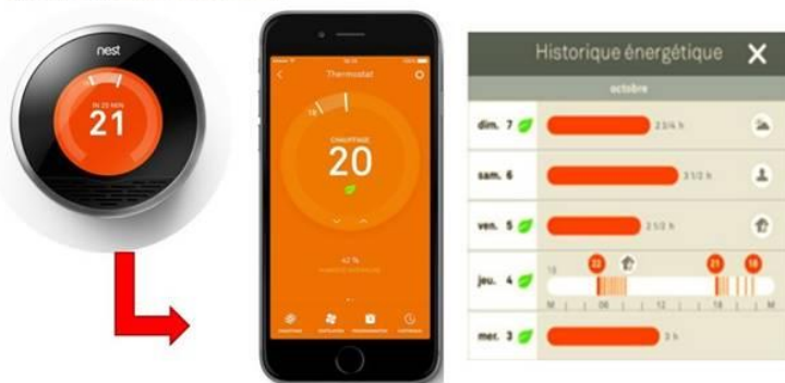
Ce thermostat peut être programmé avec un smartphone. L'application permet de contrôler à distance plusieurs paramètres comme la météo, la présence ou l'absence du propriétaire ou les besoins de l'utilisateur.
