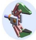
Simulation des mouvements d'une pince robot avec Edrawing
