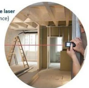
On appelle « mesure de manière directe » un résultat qui est obtenu directement à partir d'un instrument de mesure. La mesure d'une longueur avec un réglet, la mesure de la tension avec un multimètre ou la mesure de la vitesse avec un tachymètre permet de mesurer des grandeurs de manière directe.
