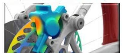
Les déformations des structures, le comportement thermique, peuvent être simulées numériquement à l'aide de logiciels adaptés. Le choix des matériaux, les formes des structures, les liaisons internes à l'objet, ... peuvent ainsi être déterminé avant la réalisation du prototype. La modélisation et les simulations de comportements permettent donc de faire des économies de recherche et développement sur les produits.
