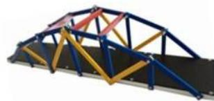
Exemple dans le cas du pont, la simulation va permettre de voir apparaître, grâce à des couleurs, les efforts de traction, compression, flexion, qui s'exercent sur l'ouvrage.
