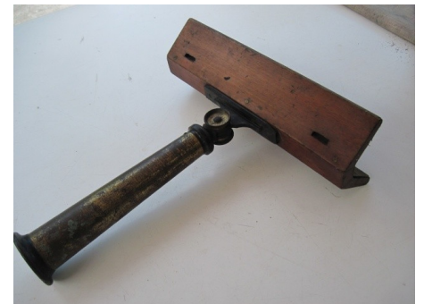
Un flash à magnésium en bois tel que celui utilisé par Nadar
