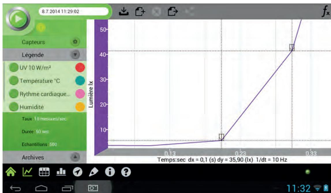
Quand il y a deux points de données sélectionnés, la différence entre ces deux points apparaît à l'avant du graphe.
