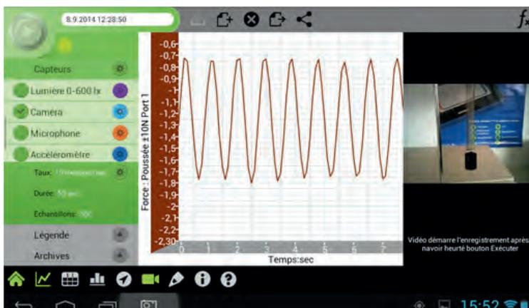
La masse sous l'effet de son poids va générer un phénomène d'oscillation s'atténuant dans le temps. Cette fonction permet de synchroniser le mouvement de l'objet tout en observant les valeurs acquises par le capteur.
